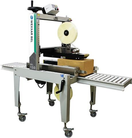
La BEL 150 est une scelleuse pour boîte semi-automatique, sensible à la pression, fabriqué à partir d'aluminium robuste C-Beam, résistant à la corrosion et d'un puissant système de transport de boîtes Uni-Drive.
